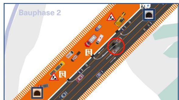
Abbildung 1 Verkehrsführung im Tunnel während der Bauphase 2 [Quelle: Autobahn GmbH des Bundes]
